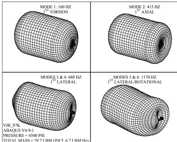
**FIGURE 8. PRESSURE VESSEL VIBRATION MODES @ 4500 PSI**
