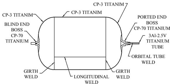
**FIGURE 11. LINER CONFIGURATION**
