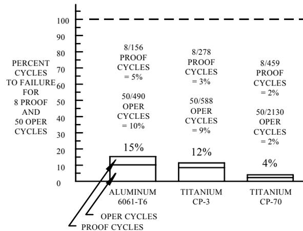
**FIGURE 2. LOW CYCLE FATIGUE LIFE NOMINAL STRAINS**
