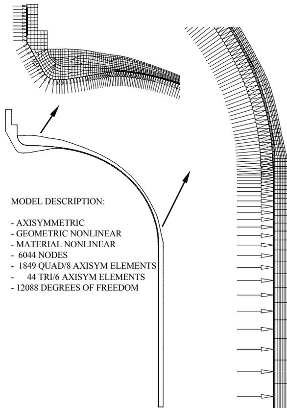
**FIGURE 5. NONLINEAR AXISYMMETRIC FINITE ELEMENT MODEL**
