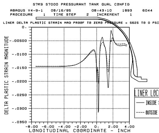
**FIGURE 7. LINER DELTA PLASTIC STRAIN MAGNITUDE PROOF PRESSURE TO ZERO PRESSURE**
