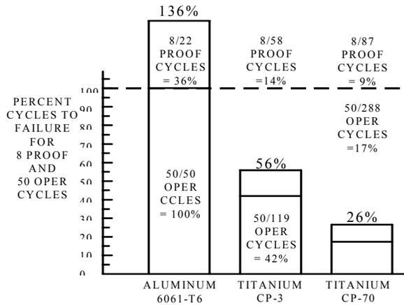
**FIGURE 3. LOW CYCLE FATIGUE LIFE PEAK STRAINS**
