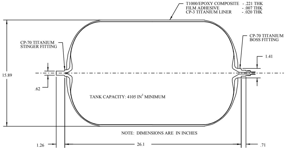
**FIGURE 1. TITANIUM LINED COMPOSITE OVERWRAPPED PRESSURE VESSEL**
